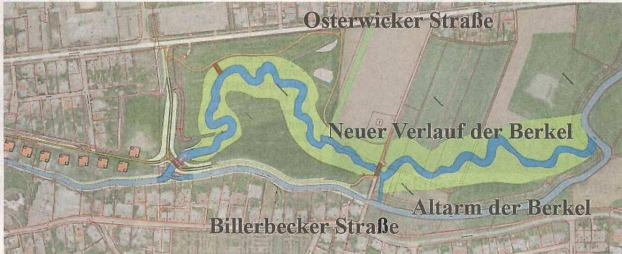
Der Plan zeigt das Hochwasserrückhaltebecken Fürstenwiesen mit dem neuem – geschlängelten Verlauf – der Berkel.
